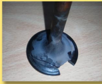
Combustion Gas / အိတ်ဖောငွေ့များ ထွက်လာ၍ ဗား၏ မျက်နှာပြင်များကွဲအက်ခြင်း၊ လောင်ကျွမ်းအရည်ပျော်ခြင်း
