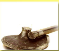
ဗား (Valve) တိုင်တွင် ကာဗွန်ဂျီးများကပ်ကာ Valve အောက်ခြေပျက်စီးခြင်း
