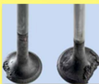
ဗားတိုင် (Valve Stem) နှင့် ဗားတိုင်ထိန်း (Guide) ကြားတွင် အနည်များ စုပုံလာခြင်းကြောင့် ဗားတိုင်ကြပ်လာခြင်း။
